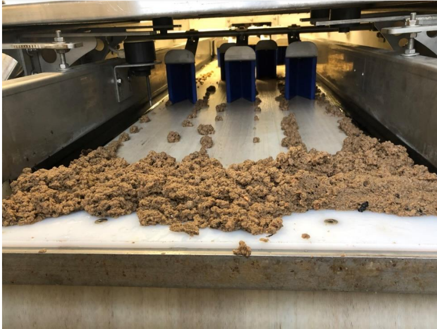
Figur 8. Fotografi av slam från Miljökassen efter att det har gått igenom avvattningsprocessen vid anläggningen i Postviken.
