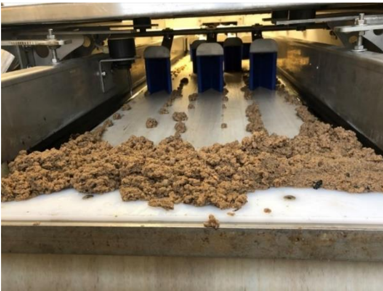
Figur 5. Fotografi av förtjockat slam efter att det har gått igenom avvattningsprocessen vid anläggningen i Postviken.
