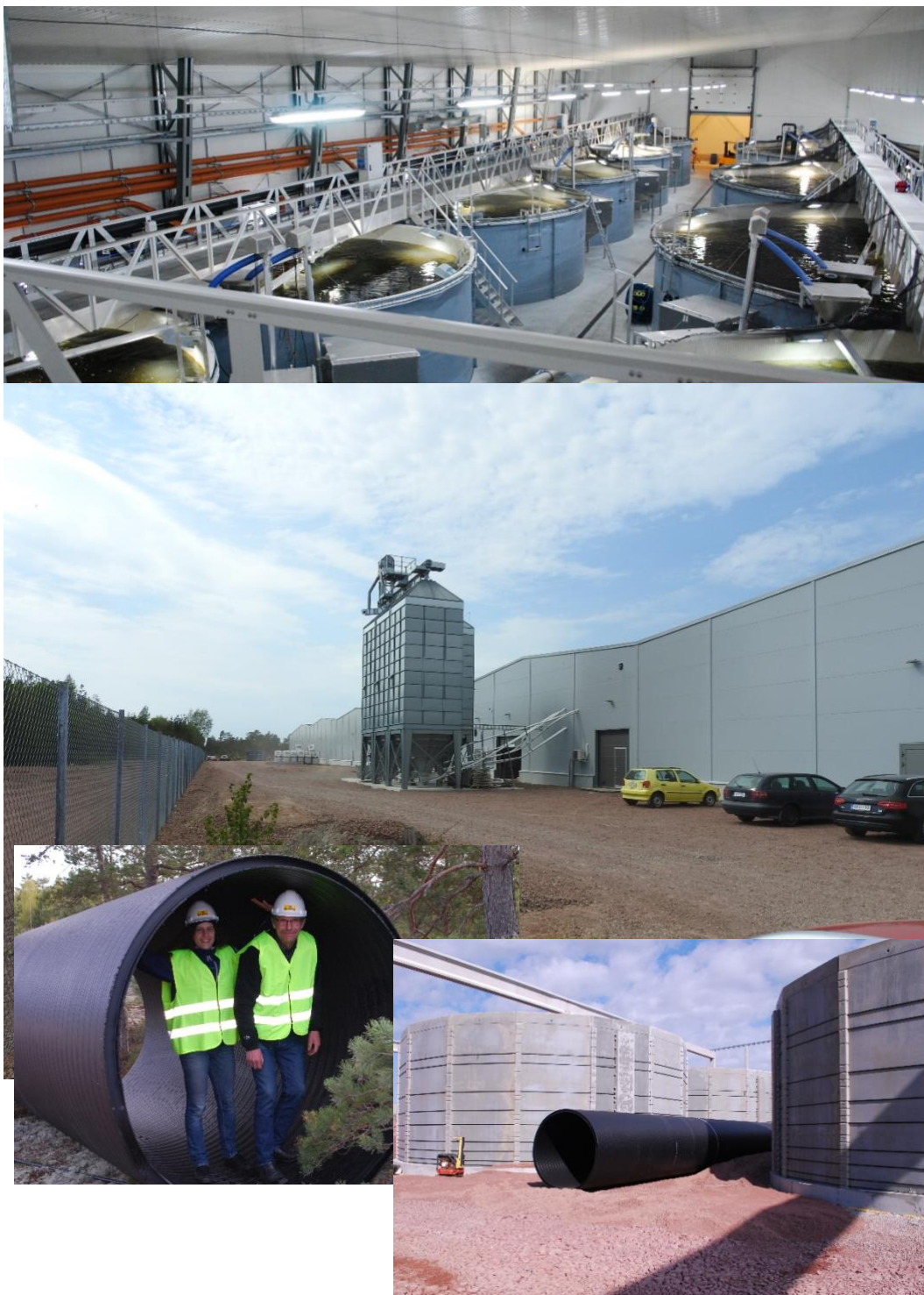
Bild 7. Överst ser vi ett klassiskt RAS för att producera sättfisk/smolt (Stavanger, Norge). Det har betydligt mindre tankar och volym än ett RAS designat för att producera stor matfisk. Den nedre bilden visar ett sådant industriellt matfisk-RAS på Åland (finns inget i Sverige idag), designat för att kunna producera ca. 3.000 ton stor regnbåge per år. De inklippta bilderna illustrerar storleken på produktionsenheterna. Man har till dagens datum nått en årsproduktion om 1.000 ton, men hoppas att inom ett antal år kunna nå tänkt produktionsvolym.
